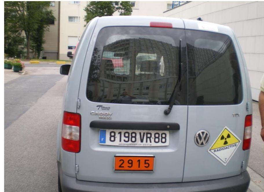
**2 plaques oranges** (vierges ou codifiées résistantes à un incendie de 15 minutes à l'avant et à l'arrière du véhicule)
