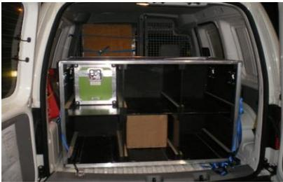
Une caisse en bois adaptée à la forme et aux dimensions des colis à charger, est arrimée au plancher du véhicule avec deux sangles d'arrimage, aux 4 points d'ancrage du plancher. La caisse dispose d'une paroi arrière fermée.
